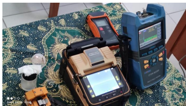
Gambar 4.3. Alat Praktik dalam penyambungan Fiber Optic.
